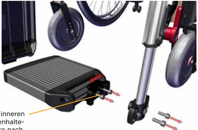
Die beiden jetzt sichtbaren inneren Schrauben an der Fußplattenhalterung lösen und die Fußplatte nach vorn oder hinten in die gewünschte Tiefe schieben.
