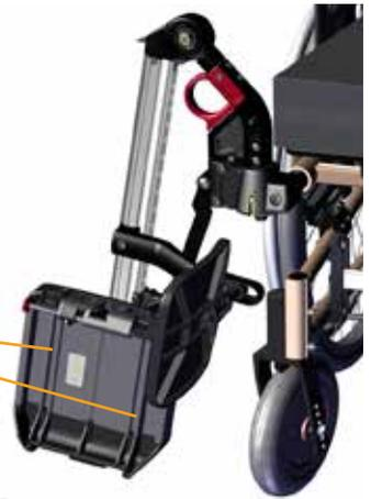
**Manschettenlasche an der rechten Fußplatte montieren:** Die rechteckige Mutter in die Nut schieben und die Lasche wie gezeigt befestigen:
