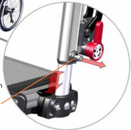
Der Abstand zwischen Fußplatten und Boden muss bei Nutzung in Innenräumen mindestens 20 bis 30 mm betragen, beim Fahren im Freien mindestens 30 bis 40 mm, damit der Rollstuhl nicht an Unebenheiten hängen bleibt. Eine Skala an der Innenseite des inneren senkrechten Aluminiumprofils erleichtert das Notieren der Höheneinstellung und die identische Einstellung beider Beinstützen.
