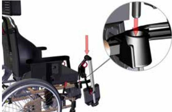
Um die Beinstütze abzunehmen, die Beinstütze an dem runden Entriegelungsgriff gerade nach oben herausziehen.
