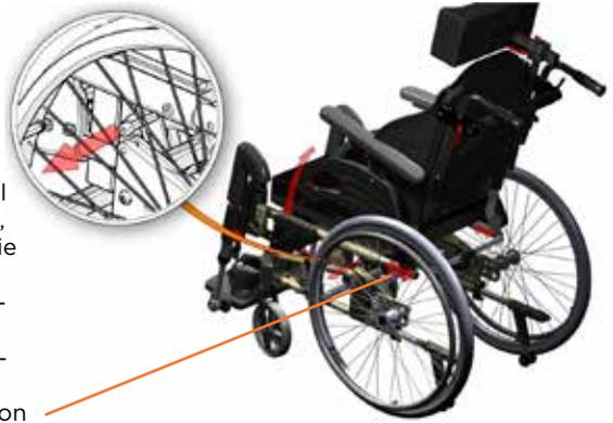
Einstellung bei Netti 4U: Den Bolzen entfernen, der den Kopf des Zylinders für die Rückenlehnenneigung hält, und in die Öffnung schieben, die zu der zuvor eingestellten Rückenlehnenhalterung passt. Dies hat auch Einfluss auf den Winkel der Rückenlehne.
