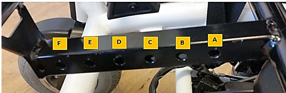
Löcher A - F für Positionierung von 80172 an Sitzrahmen-Halterung
