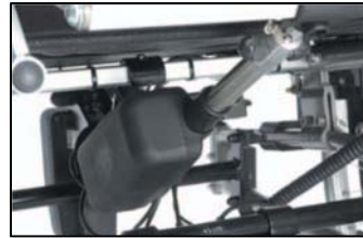
Aktuator Sitzkantelung + Rückenverstellung
