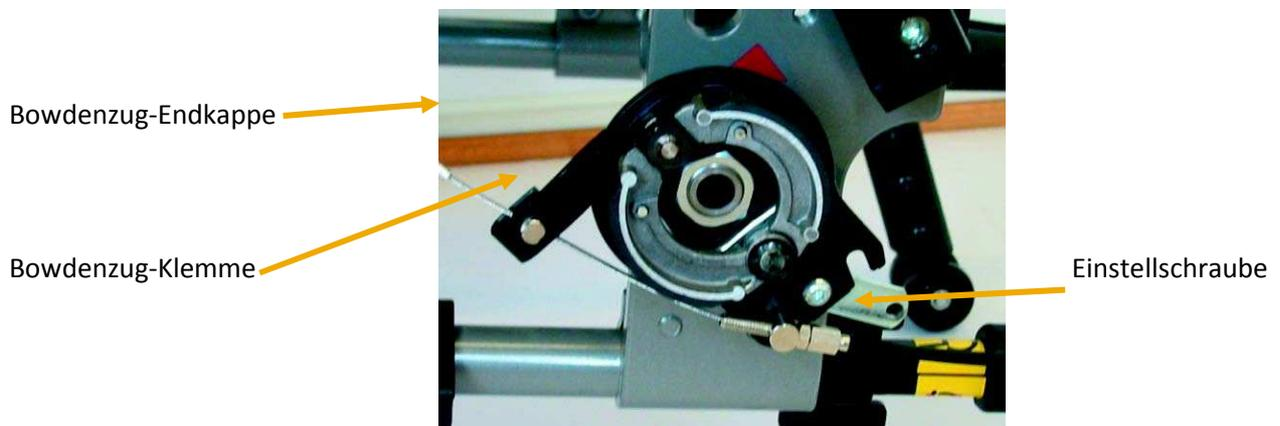
Schieben Sie den Bowdenzug durch die an der Trommelbremse befindliche Einstellschraube und Bowdenzug-Klemme.
