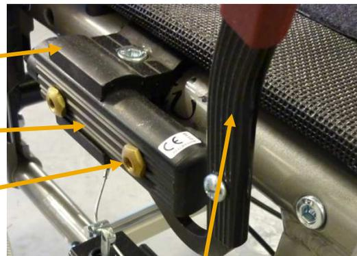
Die Bremse muss sich in einer aktiven Position befinden. Hierzu drücken Sie den Bremshebel nach vorne.
